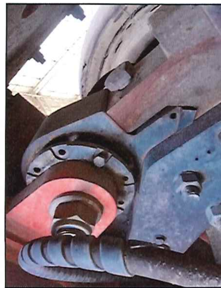
Local: Direção Item # 39: desgaste nos componentes da bucha da balança de direção. Status: corrigido .
